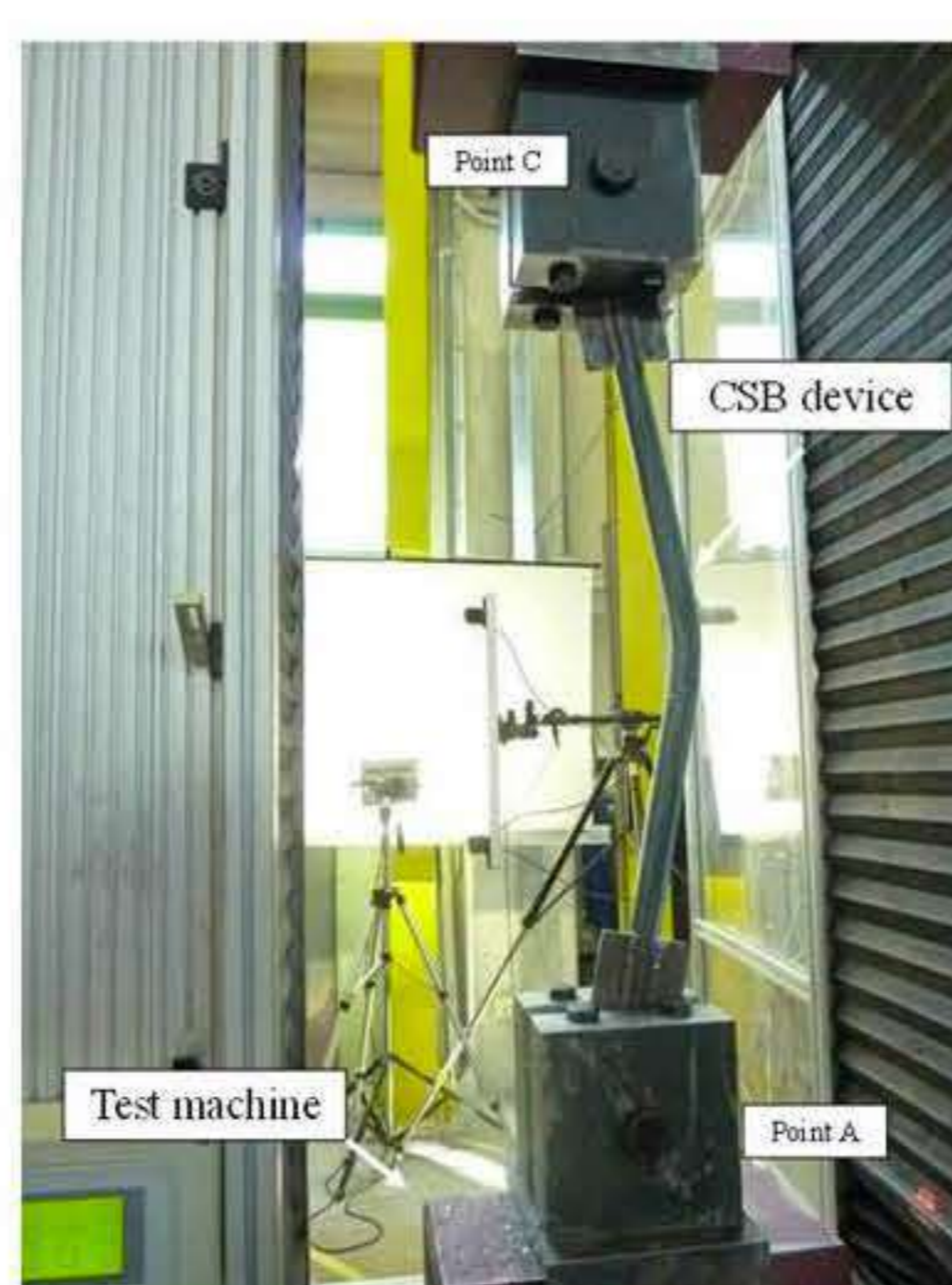
Test a compressione ciclica di un prototipo di CSB in scala 1:6.
