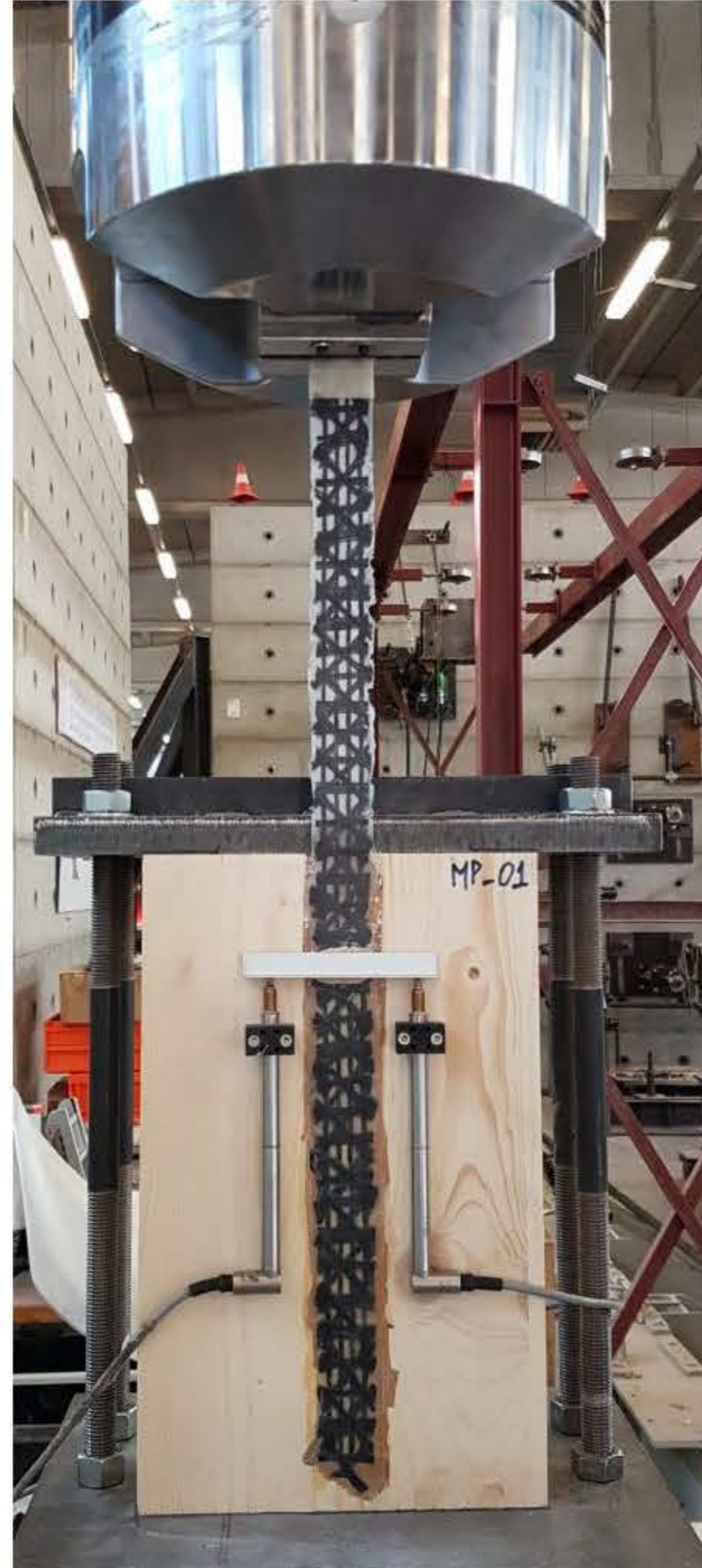
Prova di aderenza su rinforzo in tessuto multiassiale applicato su supporto ligneo.
