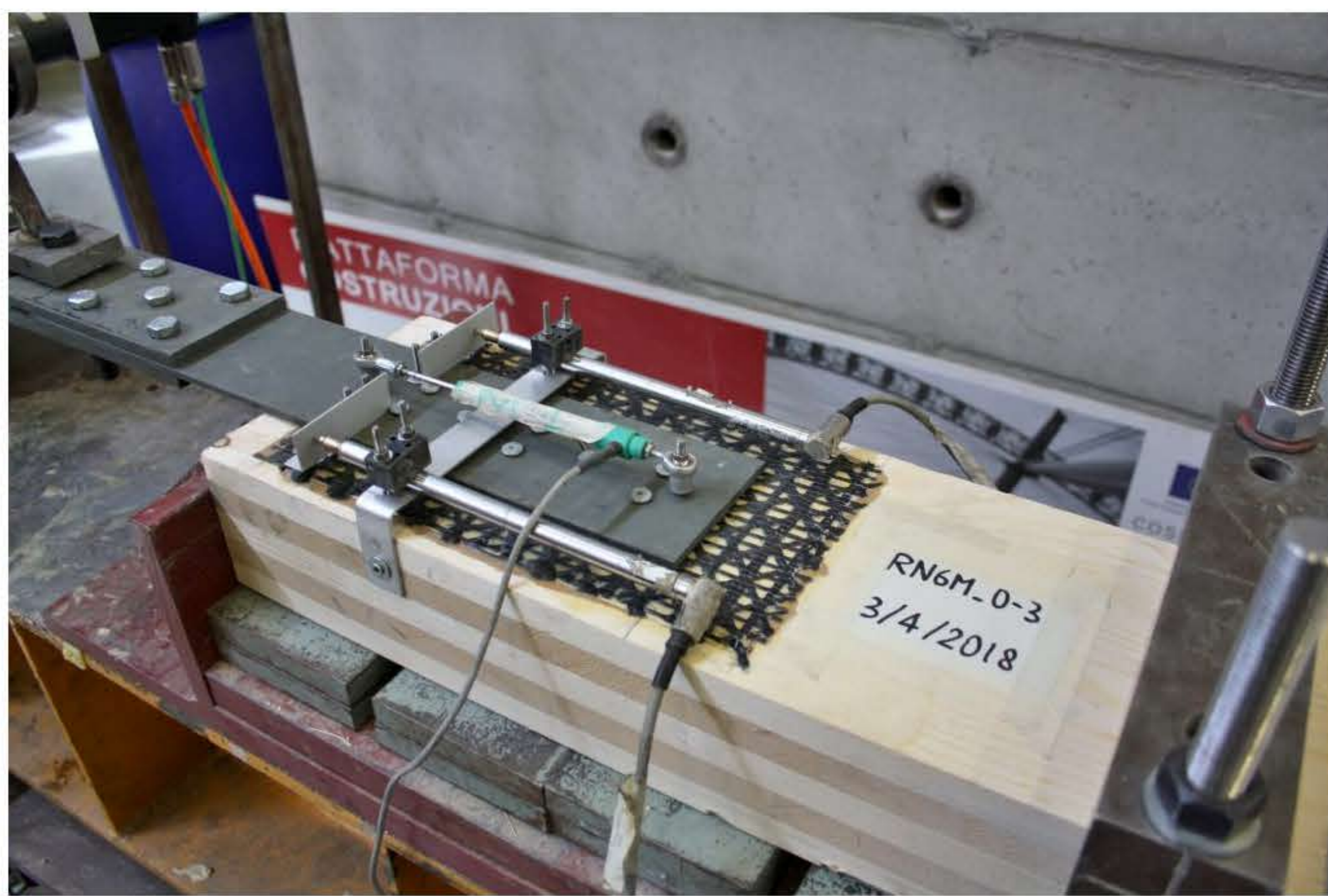
Test su connessione chiodata dopo il preventivo rinforzo della superficie lignea con materiale composito.
