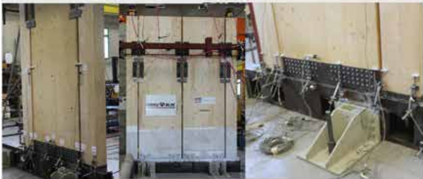
Posizionamento dei dissipatori su pareti accoppiate e particolari di aggancio
