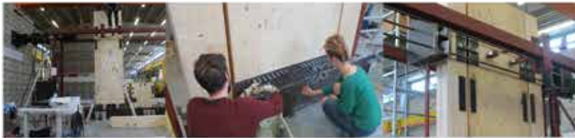
Prove sperimentali a scala reale per il collegamento dissipativo tegolo-trave
