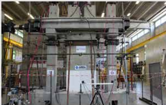
Prove sperimentali a scala reale sul sistema parete e dissipatori
